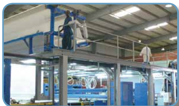
Beschichtungsanlage für Teppich Back coating line for carpet
