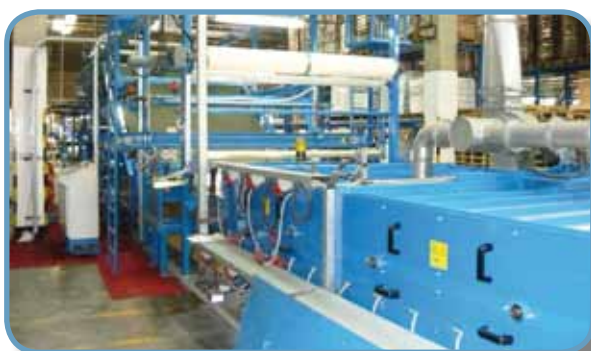
Beschichtungsanlage für Teppichfliesen Back coating line for carpet tiles
